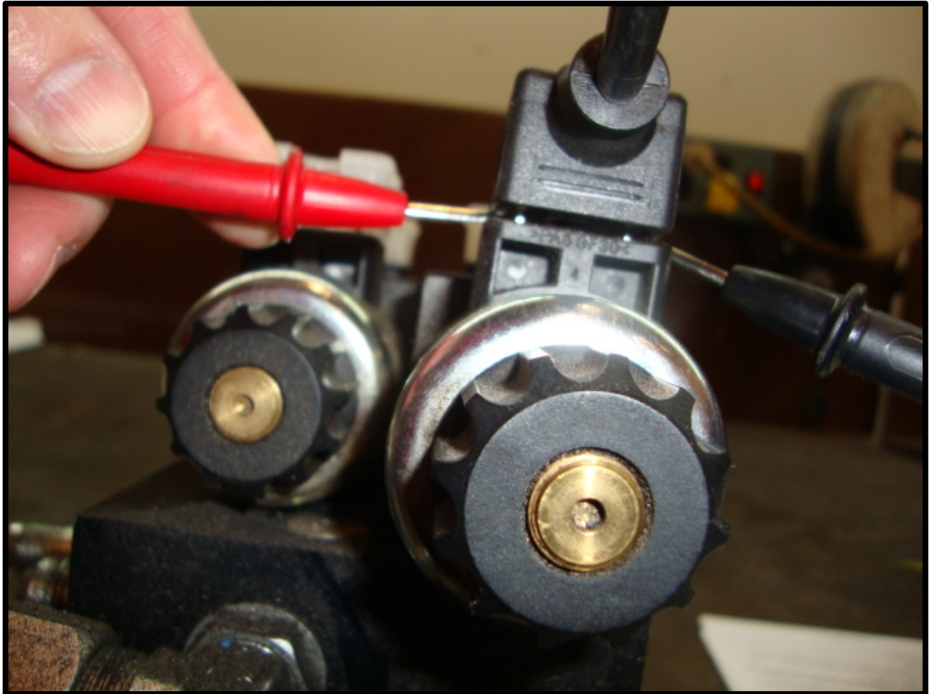
Fig. 8-4 Checking Din Plug Voltage
