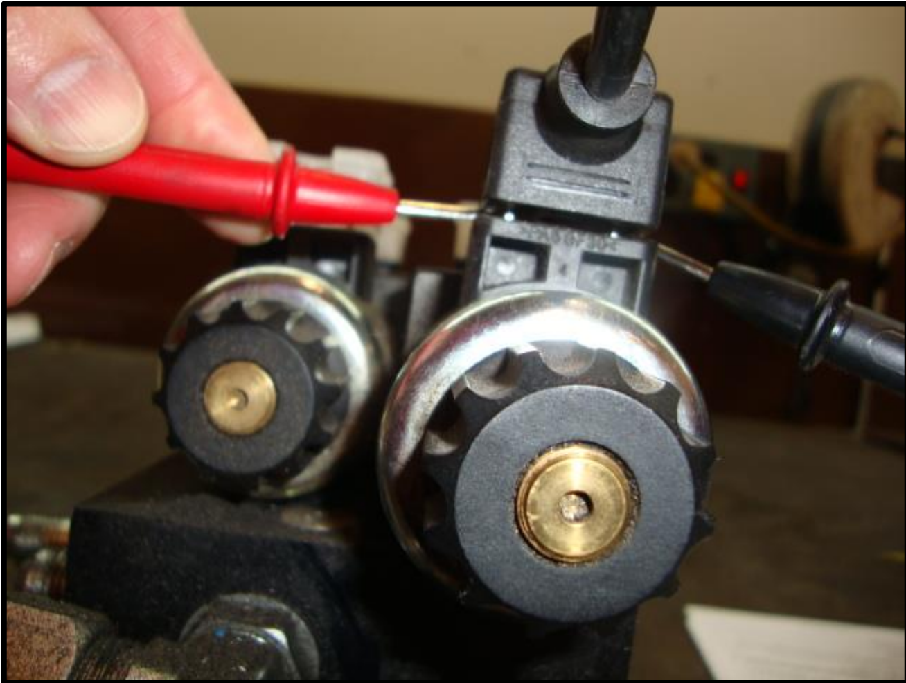
Fig. 8-4 Checking Din Plug Voltage
